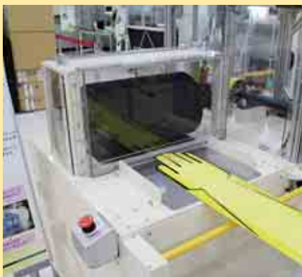
毎分60回転しているローラーに人の手に見立てたビニル板を入れて一度巻き込まれると容易に脱出できないということを体感します。
