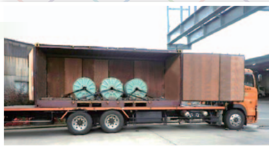
鋼線の輸送に20フィートコンテナを利用(最大積載量8.8トン・積載重量7トン)
