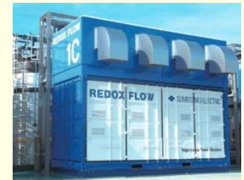
レドックスフロー電池
