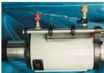
■ 緊張ジャッキ
