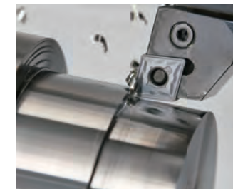
チップによる旋削加工
