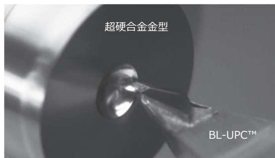
写真15 BL-UPCによる超合金金型加工
