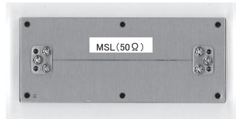
図3 伝送特性評価用MSL基板（当社フッ素樹脂基板）
