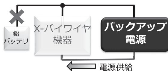
図1 X-バイワイヤ機器とバックアップ電源
