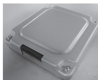
写真1 X-バイワイヤ用バックアップ電源外観
